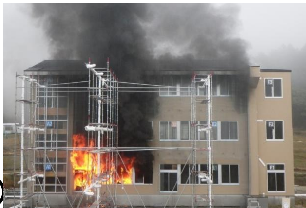
木造3階校舎の火災実験
