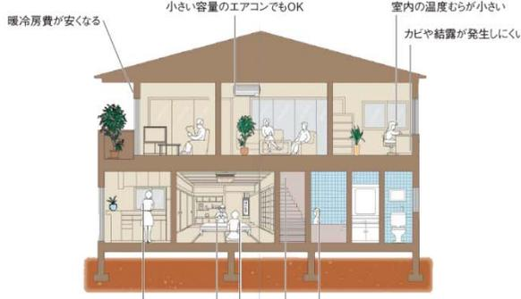
外皮性能(断熱性能, 日射遮蔽性能)向上による効果
